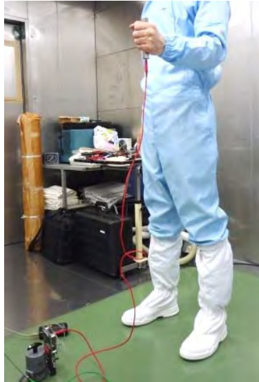
図 9.4 歩行帯電測定例(クリーンツナギ/ブーツ着用)
