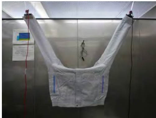
図 4.3 作業服(綿混)右袖－左袖抵抗測定例
