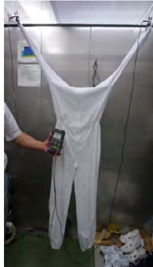
図 4.2 クリーンウェア(ツナギ)左袖－右袖抵抗測定例
