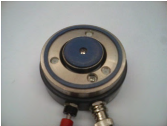
図 10.3 同心円リング型プローブ
