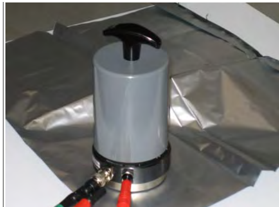
図 10.4 実際の測定の様子 (同心円リング上に 2.5 kg の重りを乗せる)
