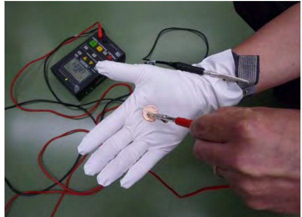
図 6.2 RCJS-5-1 附属書 A.3.3 に規定されている手袋の抵抗測定の実例
